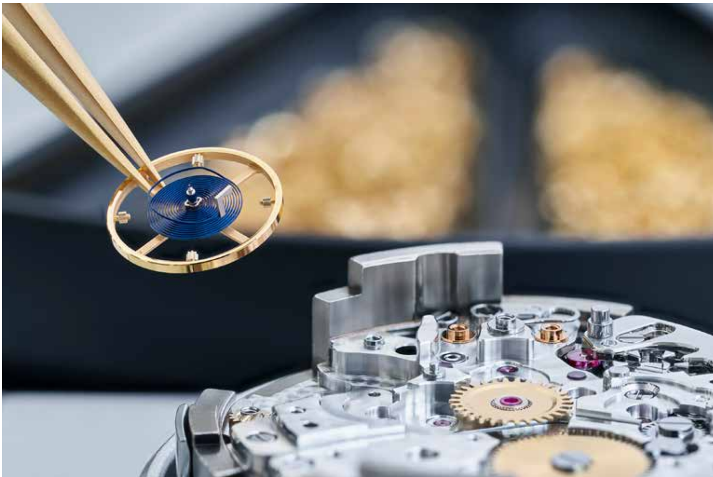
Integración del oscilador en el movimiento © Rolex/Cédric Widmer
